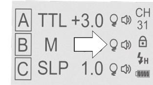
**WICHTIG!** Die Pilotlichtsteuerung funktioniert nur mit GlareOne Leuchten.
