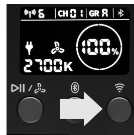
(1) Nacisnąć klawisz radiowego sterowania. W efekcie w lewym górnym narożniku LCD zacznie migać ikona zdalnego sterowania.
