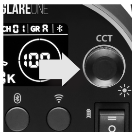
(1) Wcisnąć pokrętkę sterującą - na ekranie LCD zacznie migać litera K
